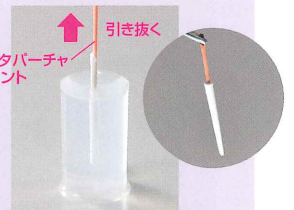
硬化したメタシールSoft ペーストを確認
