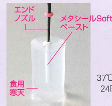
食用寒天の根管模型にメタシールSoft ペーストを充填
