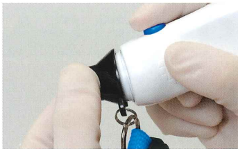
校正キャップをつけてキャリブレーション
