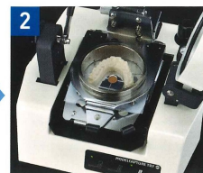
製作した模型に分離材を塗布し、シート・模型をセット
