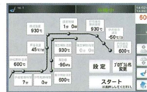
basicモード炉内徐冷設定時
